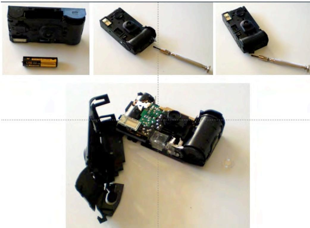
Spätestens nun ist „**Höchste Vorsicht**“ geboten, denn der sich im Schaltkreise befindliche große Kondensator mag noch eine mit der körperlichen Unversehrtheit unvereinbar hohe Strommenge in sich bergen. Mittels einer isolierten Greifzange entfernt man zuerst den
