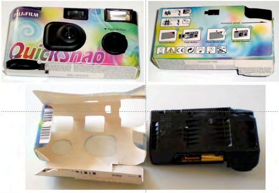
Danach werden die Hebelkräfte mittels Schraubendreher an den vorbestimmten Laschen so wirkungsvoll angesetzt, dass der anfängliche Widerstand rasch erlahmt und die Kamera ihr Innerstes preisgibt.
